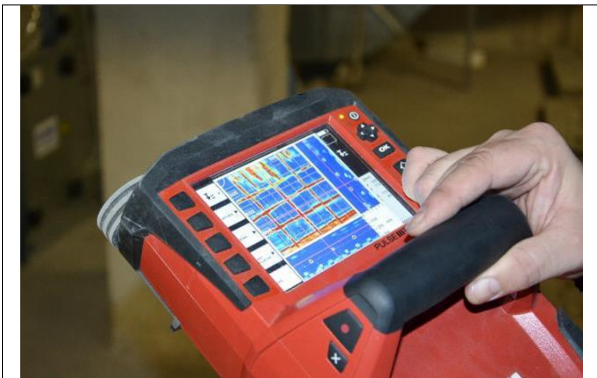
Obr. 2.1: Sonda přístroje Hilti PS1000, na displeji patrná poloha detekované výztuže v půdorysném schématu i řezech ve dvou, na sebe kolmých rovinách
