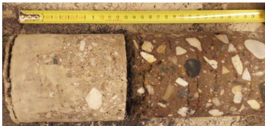
Obrázek 65: Vývrt V3 (strop nad 2.NP, kancelář). Horizontální trhlinky (vysychací, smršťovací) v nosné části betonu.
