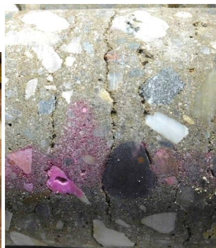
Obrázek 65: Vývrt V3 (strop nad 2.NP, kancelář). Horizontální trhlinky (vysychací, smršťovací) v nosné části betonu.
