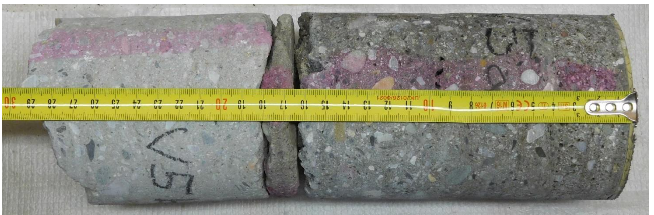
Obrázek 72: Vývrt V5 (strop nad 3.NP, chodba).
