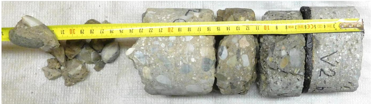
Obrázek 62: Výtvt V2 (strop nad 2.NP, koupelna). Rozpadlý vzorek, nekompaktní beton nosné části.
