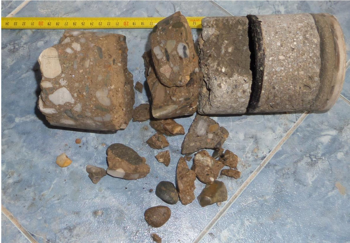
Obrázek 62: Výtvt V2 (strop nad 2.NP, koupelna). Rozpadlý vzorek, nekompaktní beton nosné části.
