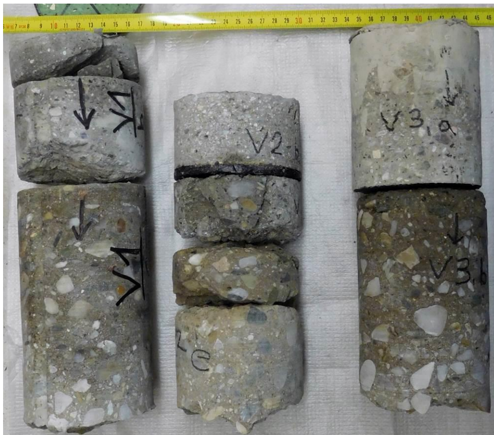
Obr. 25 – Jádrové vývrty ze stropní desky nad 2.NP.
