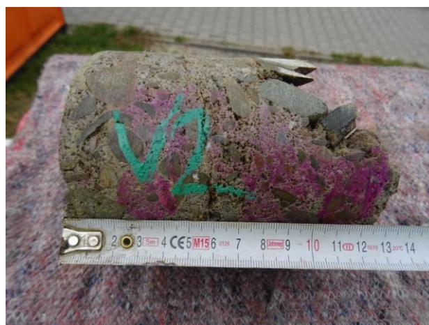
V2. Karbonatce do hloubky 70 - 80 mm. Proměnná vzhledem k heterogenitě struktury.
