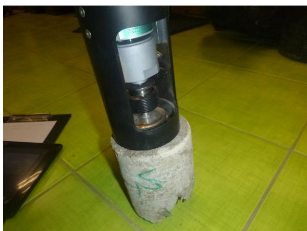
Pohled na samotnou zkoušku pevnosti v tahu na vývrty V2.
