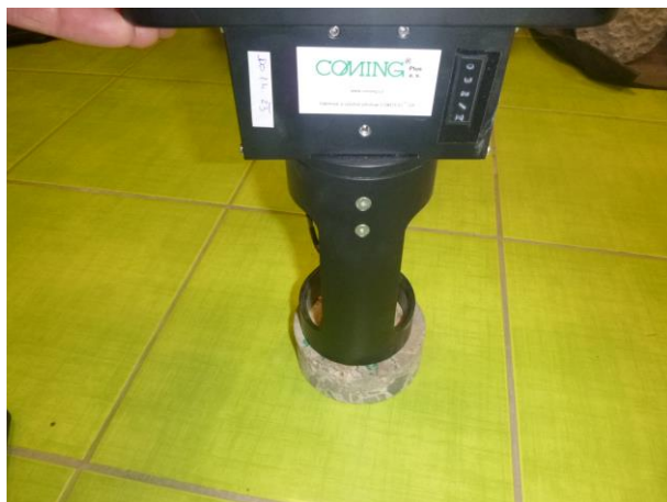
Pohled na samotnou zkoušku pevnosti v tahu na vývrty V1 trhacím přístrojem COMTEST OP3.
