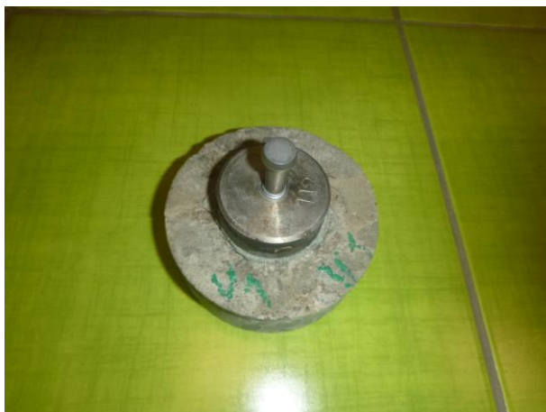
Pohled na nalepený terč vývrty V1.
