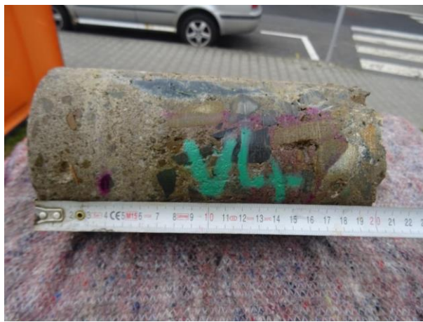
V4. Karbonatace do hloubky 120 a více, proměnná vzhledem k heterogenitě struktury.
