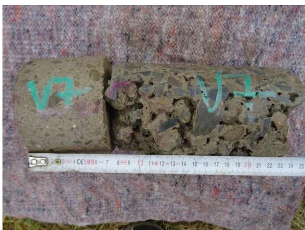
V7. Karbonatace do hloubky 230 a více, proměnná vzhledem k heterogenitě struktury a pórovitosti.
