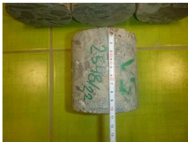
Pohled na jediný upravený vzorek z dříku spodní stavby.
