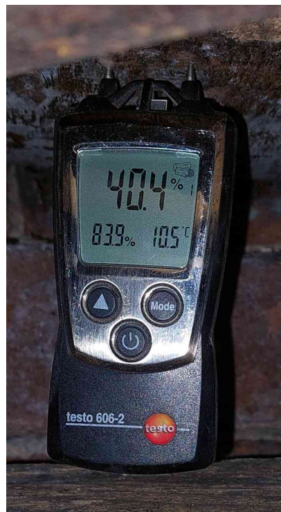
Obr. 1: vlhkost a teplota vzduchu
